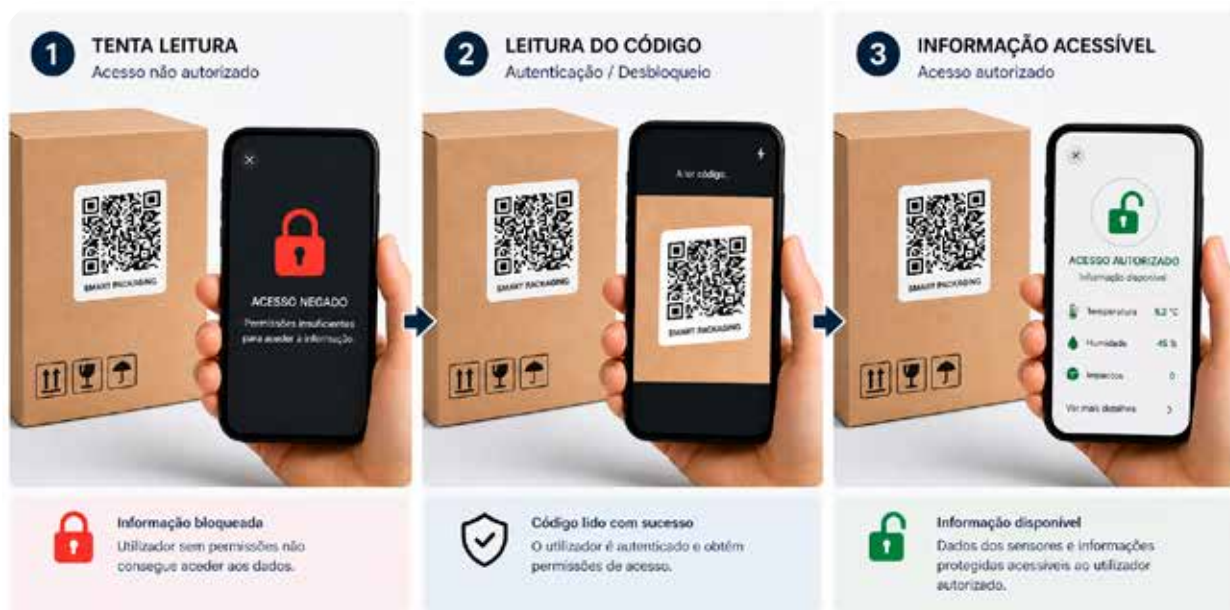
Seqüência de interação com a embalagem inteligente: tentativa de acesso não autorizado, leitura do código por um utilizador autorizado e desbloqueio da informação após autenticação.
