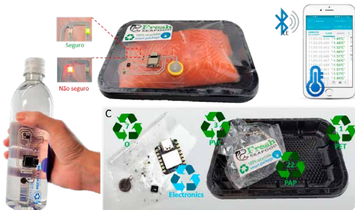
Circuitos impressos recicláveis para monitorização contínua da temperatura de embalagens ao longo de toda a cadeia logística
