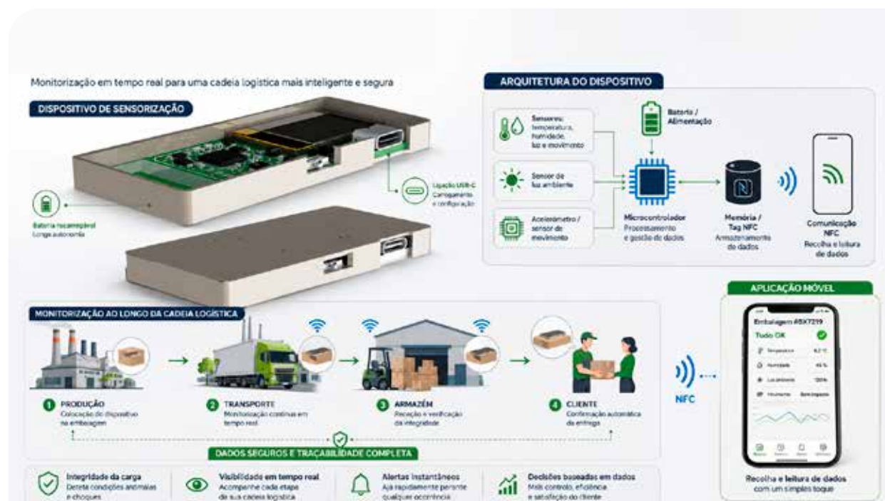
Sistema de sensorização para embalagens inteligentes, com monitorização por NFC ao longo da cadeia logística.
